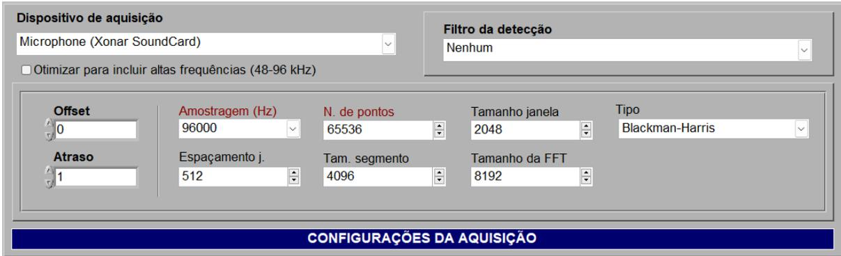
Figura 103 - Seção para configuração dos ajustes avançados do processamento do sinal.
