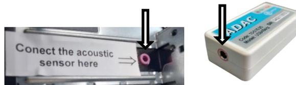
Figura 16 - Entrada de áudio da placa de aquisição XONAR, instalada no painel traseiro de um computador DELL, e do módulo de aquisição ADAC. A entrada de áudio é sempre um conector P2.
