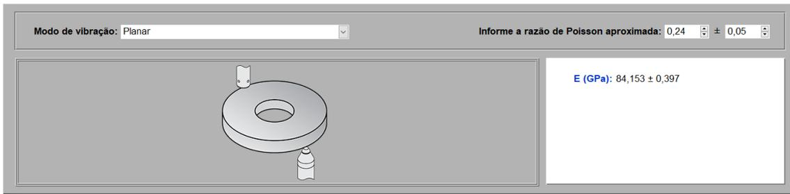
Figura 55 - Módulo do Software Sonelastic® com a opção “Planar” seleccionada. Exemplo de medição de uma amostra de rebolo.
