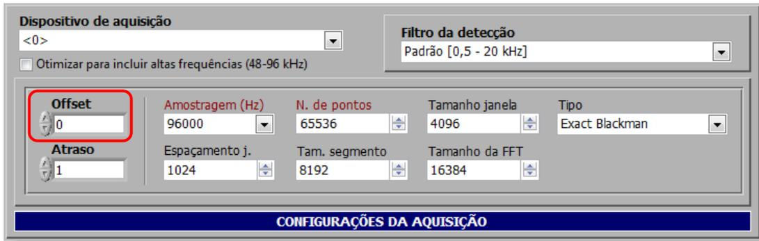
Figura 35 - Seção para ajuste do "Offset".
