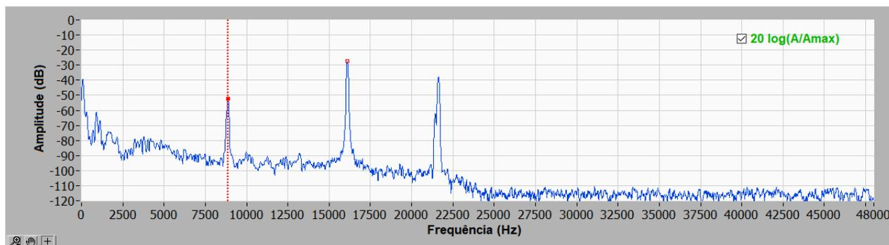
Figura 68 - Gráfico de amplitude versus freqüência para a escolha da freqüência na aba Amortecimento-TF.
