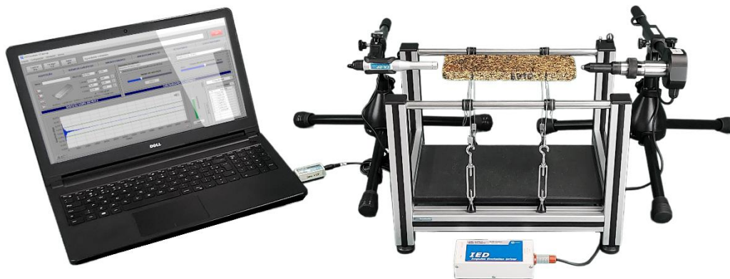
Figura 10 - Sistema Sonelastic® desenvolvido pela ATCP Engenharia Física para a determinação dos módulos elásticos de corpos de prova de madeira e derivados com a Técnica de Excitação por Impulso.
