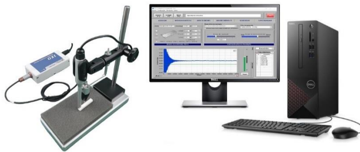
Figura 17 – Sistema Sonelastic® para corpos de prova de pequeno porte utilizado neste estudo para a medição dos laminados. Destaque para o Software e para o Suporte SB-AP.
