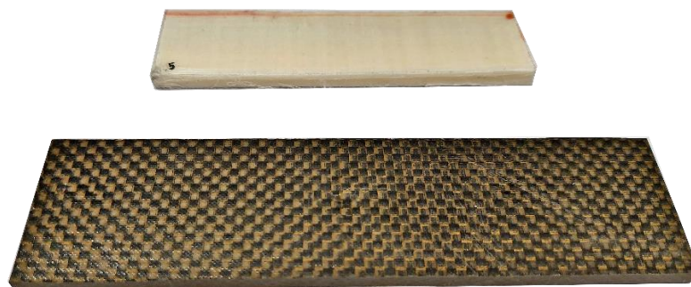
Figura 3 - Corpos de provas de uma blindagem balística de polietileno de ultra alto peso molecular (UHMWPE) e de um painel aeronáutico monolítico de plástico reforçado com fibra de carbono (CFRP). Estes corpos de prova estão preparados para a medição não-destrutiva dos módulos elásticos empregando a Técnica de Excitação por Impulso e os Sistemas Sonelastic® [6].
