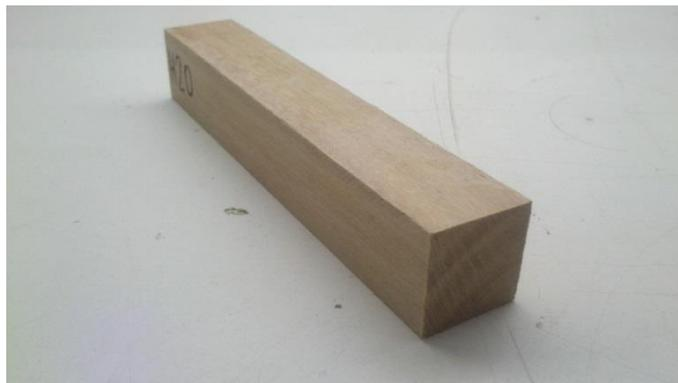
**Figura 8** - Corpo de prova com fibras na direção do comprimento (*L*).
