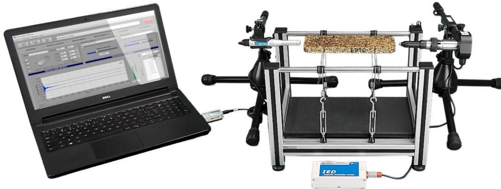
**Figura 10** - Sistema [Sonelastic®](http://www.sonelastic.com) desenvolvido pela ATCP Engenharia Física para a determinação dos módulos elásticos de corpos de prova de madeira e derivados com a Técnica de Excitação por Impulso.
