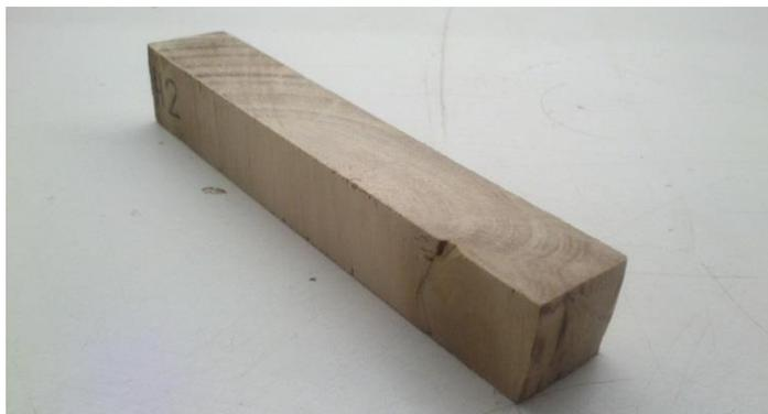
**Figura 9** - Corpo de prova com fibras nas direções radial e tangencial (*RT*).
