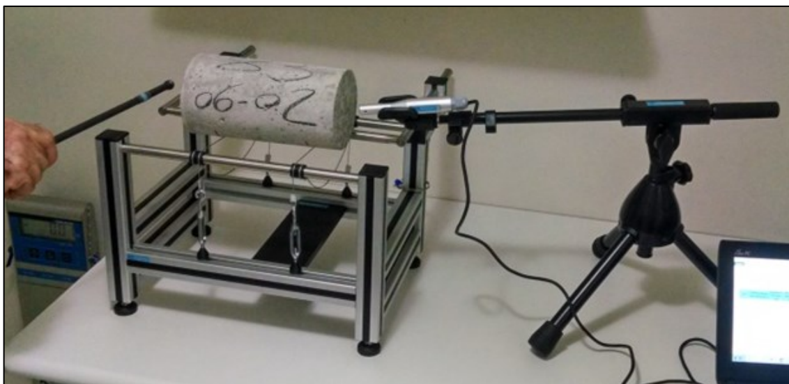
Fotografia 4 – Forma de aplicação do impulso e aquisição da resposta acústica, frequência de ressonância fundamental longitudinal.
