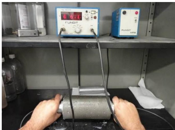
Fotografia 2 – Procedimento do ensaio de ultrassom.
