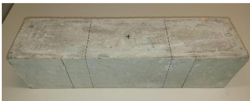
Figura 10 – Marcação do corpo de prova para facilitar o posicionamento, a excitação e a captura da resposta acústica.
