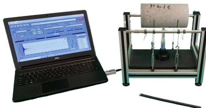
Figura 8 – Sistema Sonelastic para corpos de prova cilíndricos e prismáticos de concreto.
